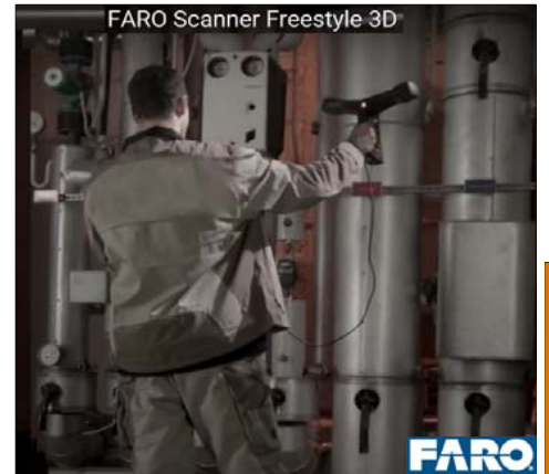
FARO社 Scanner Freestyle3D (ハンディーレーザー型)
